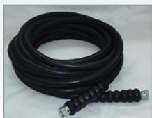
Manguera de doble malla de acero de 10 mts, D.I. 3/8" Con presión de operación de 10000 psig, 160°C.
